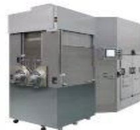
半導体シリコンウェハー用 ワイヤーソー [コマツNTC]
